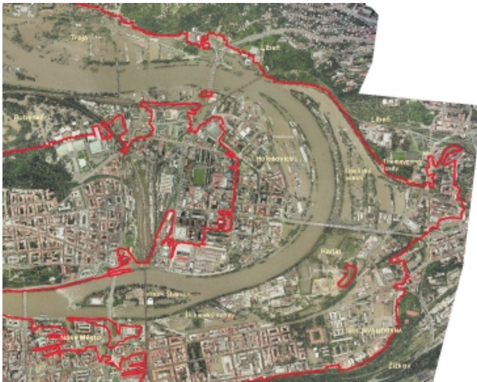
Obr. D7.4 Ukázky dokumentace zaplavených území s využitím leteckých snímků, srpen 2002 Illustrations of the flooded areas documentation using aerial photography, August 2002
